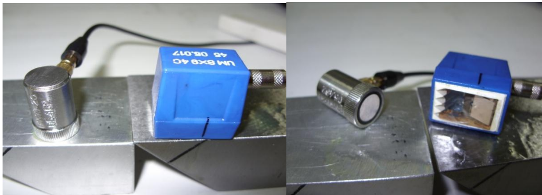
Fig. 6. Palpatoarele de emisie recepție pentru generarea undelor longitudinale și transversale
