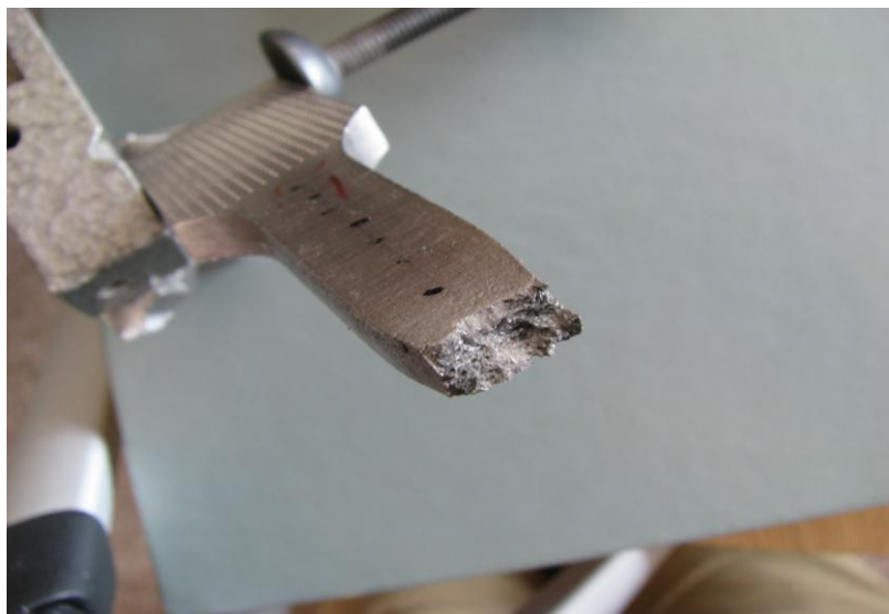
Fig. 5. Aspectul suprafeței rezultate ca urmare a sollicitării de tracțiune până la rupere
