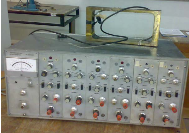
Tensometru IAEMI, cu 6 canale
