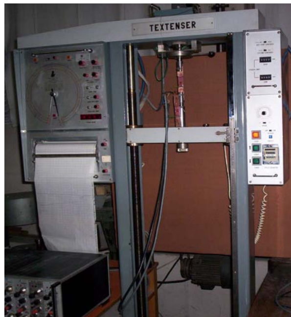
Masina universala de incercat la tractiune Textenser, 5 kN
