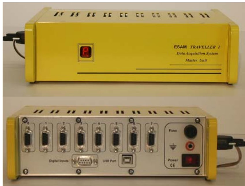
Sistem de achizitie date ESA Messtechnik Traveller 1 (master unit)- vedere din fata/spate
