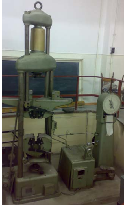
Masina universala de incercat WEB, 400 kN, cu incinta termica
