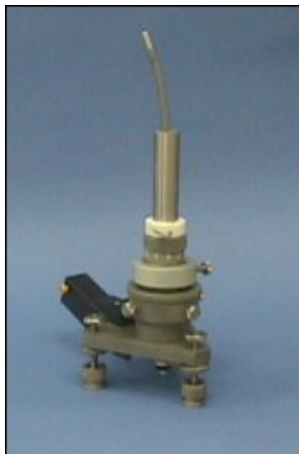
Sistem pentru determinarea tensiunilor remanente Vishay RS 200 (compresorul nu este prezentat)
