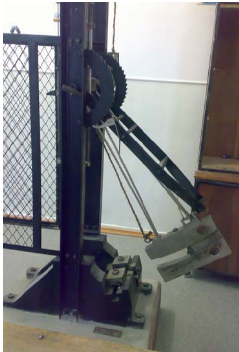
Pendul pentru determinarea rezilientei (metoda Charpy)
