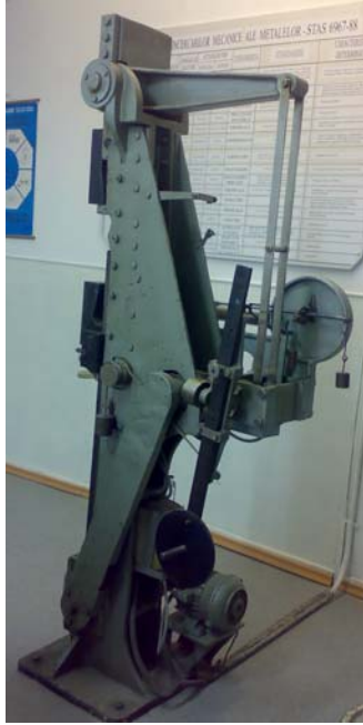
Masina de incercat la tractiune R5, 20 kN
