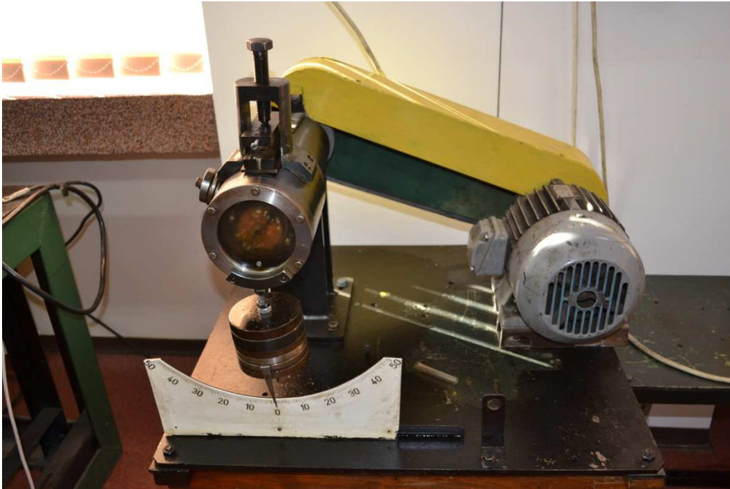
Fig. 4 Stand pentru studiul frecării în rulmenții radiali
